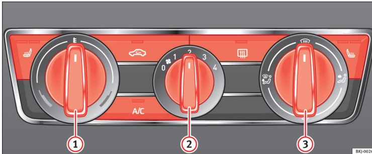
pav. 61 Viduriniame valdymo pulte: Rankinio oro kondicionieriaus mygtukai.
