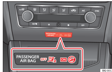
pav. 104 Vidurinė prietaisų skydo dalis: kontrolinė lemputė išjungtai priekinio keleivio oro pagalvei viduriniame valdymo skyde.
