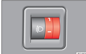
pav. 144 Prietaisŕ skydas: priekiniŕ ųibintŕ nuotolio kontrolė.
