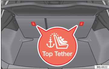
pav. 34 „Top Tether“ žiedų padėtis už galinės sėdynės.
