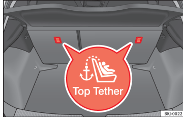
pav. 32 „Top Tether“ žiedų padėtis už galinės sėdynės.
