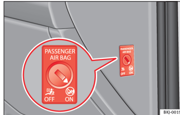
pav. 103 Jungiklis priekinio keleivio oro pagalvės išjungimui ir įjungimui.
