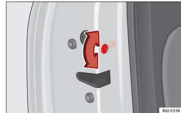
pav. 139 Apsaugos nuo vaikų užraktas kai-rės pusės durelėse.
