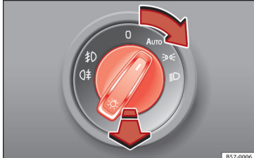
pav. 142 Prietaisų skydas: šviesumo reguliavimas.
