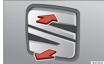
pav. 6 Bagazinės dangtis: atidarymas iš išorės.
