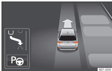
pav. 165 Prietaisų skydelio ekrane: vairavimo parkuojantis asistento indikacija su apribotu vaizdu.
