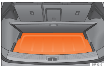
pav. 104 Bagažinėje: bagaziinės uždangalo įdėjimas.
