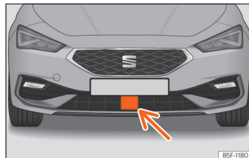
pav. 142 Priekiniame bamperyje: radaro sensorius.
