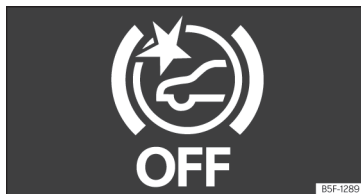
pav. 141 Prietaisų skydelio ekrane: indikacija, kad „Front Assist“ sistema yra išjungta.
