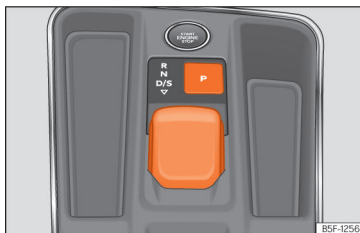
pav. 132 Vidurinėje konsolėje: važiavimo pakopų pasirinkimo jungiklis.
