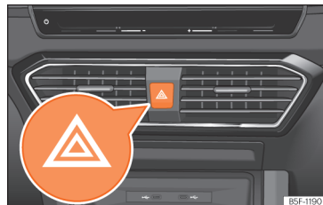
pav. 86 Prietaisų panelis: avarinių šviesų sistemos jungiklis.
