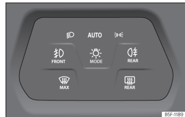
pav. 84 Prietaisų panelis: šviesų jungiklis.
