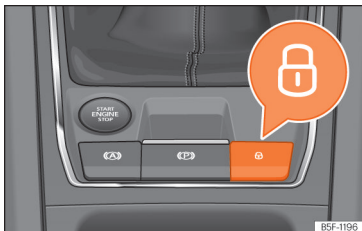
pav. 73 Vidurinėje konsolėje: centrinio užrakto mygtukas
