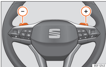
pav. 133 Vairas: automatinės pavarų dėžės svirtelės.
