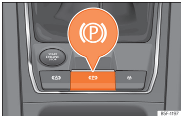
pav. 163 Apatinėje vidurinėje konsolės dalyje: elektroninio stovėjimo stabdžio mygtukas.
