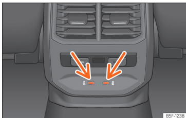
pav. 127 Vidurinė konsolė gale: USB jungtys su kištukinių lizdų funkcija.
