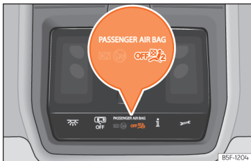
pav. 16 Lubų konsolėje: priekinio keleivio oro pagalvės išjungimo kontrolinė lemputė.
