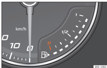
pav. 56 Analoginis prietaisų skydelis: degalų atsargų indikacija
