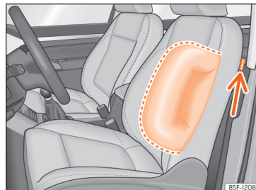
pav. 19 Šoninė oro pagalvė vairuotojo sėdynėje
