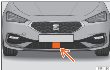
pav. 145 Priekiniame bamperyje: radaro sensorius.
