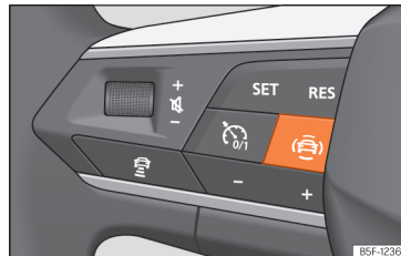
pav. 62 Kairioji daugiafunkcio vairo pusė: asistavimo vairuotojui sistemų mygtukas (priklausomai nuo modelio).
