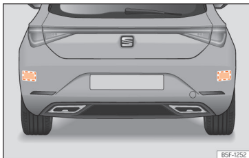
pav. 157 Automobilio vaizdas iš galo: radarų sensorių sritys.
