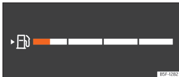
pav. 57 Laisvai konfigūruojamas prietaisų skydelis: degalų atsargų indikacija skirtingose vietose priklausomai nuo vaizdo.
