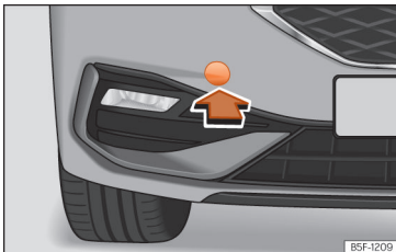
pav. 44 Dešinėje priekinio bamperio pusėje: dangtelio nuėmimas.
