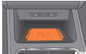
pav. 125 Vidurinėje konsolėje: mobiliojo telefono siejimo skyrius.
