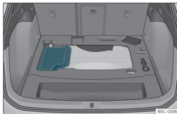
pav. 222 Akumulatoriaus sumontavimo vieta bagažinėje
