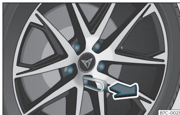
pav. 39 Ratas: rato varžtai su dangteliais.
