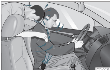
pav. 12 Saugos diržo neužsisėgęs keleivis ant galinės sėdynės sviedžiamas į priekį ant saugos diržą užsisėgusio vairuotojo.
