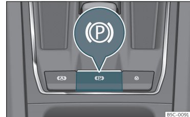
pav. 172 Apatinėje vidurinėje konsolės dalyje: elektroninio stovėjimo stabdžio mygtukas.
