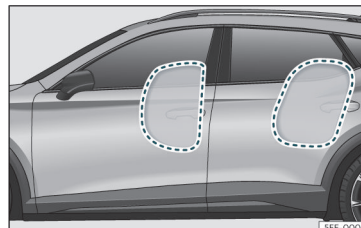
pav. 22 Visiškai pripūstos šoninės oro pagalvės kairėje automobilio pusėje.
