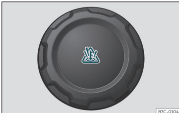
pav. 207 Variklio skyrius: variklio aušinimo skysčio plėtimosi bakelio dangtelis.
