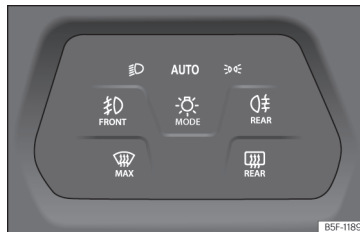
pav. 89 Prietaisų panelis: šviesų jungiklis.
