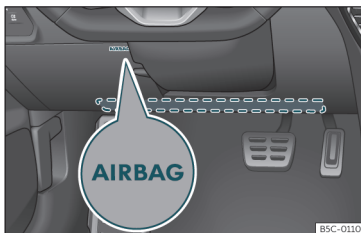
pav. 17 Vairuotojo pusėje: kelių oro pagalvės sumontavimo vieta.
