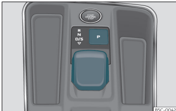
pag. 142 Vidurinėje konsolėje: važiavimo pakopų pasirinkimo jungiklis.
