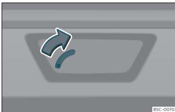
pav. 85 Bagažinės fragmentas: avarinis atrakinimas.
