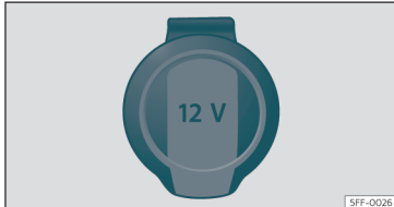
pav. 125 12 voltų kištukinis lizdas: ① priekiniame ranktūryje.
