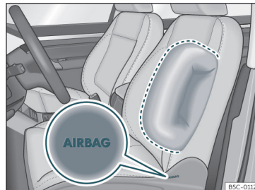
pav. 21 Šoninė oro pagalvė vairuotojo sėdynėje
