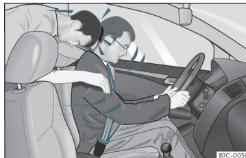
pav. 8 Saugos diržo neįsisegęs keleivis ant gretimos sėdynės sviedžiamas į priekį ant saugos diržą užsisegusio vairuotojo.
