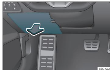
pav. 47 Prietaisų panelyje, vairotojo pusėje: saugiklių bloko dangtelis.
