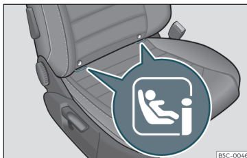
pav. 28 Priekinio keleivio sėdynė: „ISOFIX“ arba „i-Size“ laikymo kilpos.
