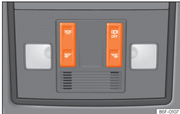
pav. 102 Lubų apmušimo fragmentas: automobilio vidaus apšvietimas priekyje.
