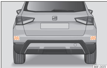
pav. 147 Automobilio vaizdas iš galo: radarų sensorių sritys.
