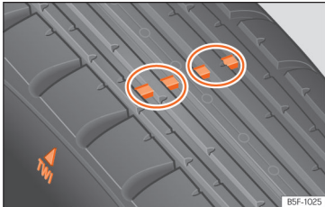
pav. 207 Padangos protektorius: nusidėvėjimo indikatoriai.
