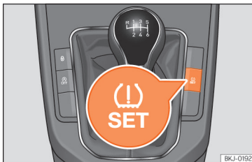
pav. 209 Vidurinė konsolė: padangų kontrolės indikacijos mygtukas.
