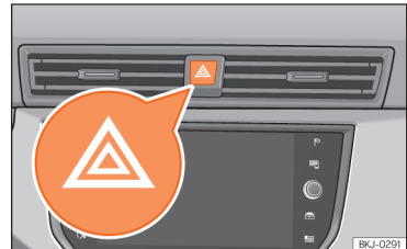
pag. 100 Prietaisų panelis: avarinių šviesų sistemos jungiklis.
