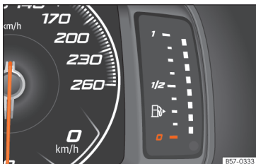
pav. 70 Laisvai konfigūruojamas prietaisų skydelis: degalų atsargų indikacija
