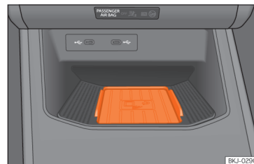
pav. 133 Vidurinėje konsolėje: mobiliojo telefono siejimo skyrius.
