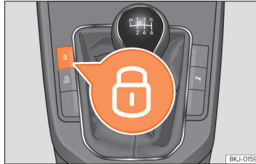
pav. 87 Vidurinė konsolė: centrinio užrakto jungiklis.
