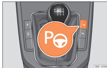
pav. 169 Vidurinėje konsolėje: vairavimo parkuojantis asistento įjungimo mygtukas.
