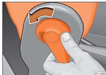
pav. 113 Nulenkiama priekinio keleivio sėdynės atlošo atrakinimas.
