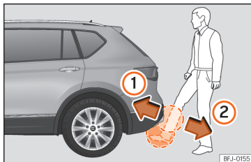
pav. 86 Galinis dangtis su sensoriniu atidarymu („Easy Open“).
