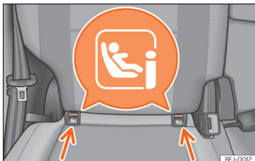
pav. 26 Antrosios sėdynių eilės išorinės sėdimosios vietos: „ISOFIX“ arba „i-Size“ laikymo kilpos.
