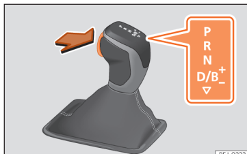
pav. 167 Važiavimo pakopų pasirinkimo svirties blokatorius (hibridiniai automobiliai).
