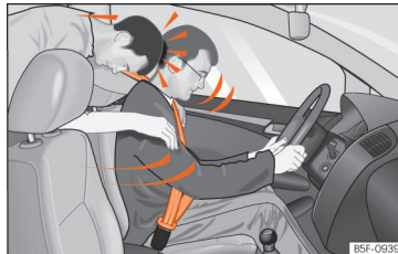
pav. 9 Saugos diržo neužsisėgęs keleivis ant galinės sėdynės sviedžiamas į priekį ant saugos diržų užsisėgusio vairuotojo.
