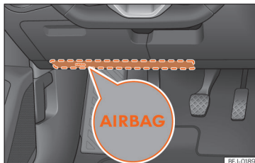
pav. 19 Vairuotojo pusėje: kelių oro pagalvės sumontavimo vieta.
