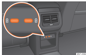
pav. 156 Vidurinė konsolė gale: USB jungtys su kištukinių lizdų funkcija.
