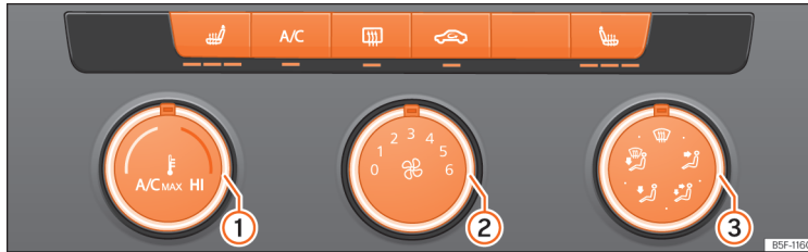
pav. 146 Vidurinėje konsolėje: oro kondicionieriaus valdymo elementai.
