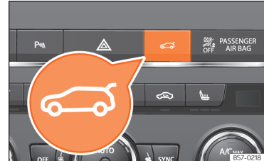
pav. 99 Vidurinė konsolė: galinio dangčio atidarymo ir uždarymo mygtukas.
