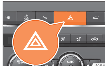
pav. 110 Prietaisų panelis: avarinių šviesų sistemos jungiklis.
