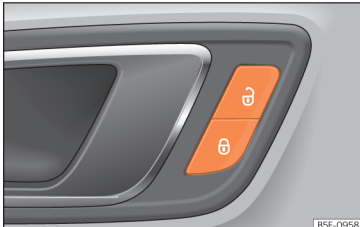
pav. 90 Vairuotojo durys: centrinio užrakto mygtukas.
