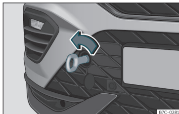
pav. 42 Dešinėje priekinio bamperio pusėje: įsukta vilkimo kilpa.
