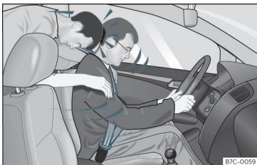
pav. 8 Saugos diržo neužsisėgęs keleivis ant galinės sėdynės sviedžiamas į priekį ant saugos diržą užsisėgusio vairuotojo.
