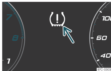
pav. 212 Prietaisų skydelis: įspėjimas dėl slėgio padangose kritimo.
