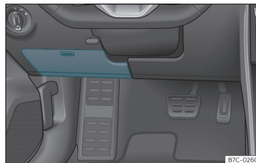
pav. 45 Automobilis su vairu kairėje: saugiklių bloko po prietaisų paneliu vairuotojo pusėje dangtelis.
