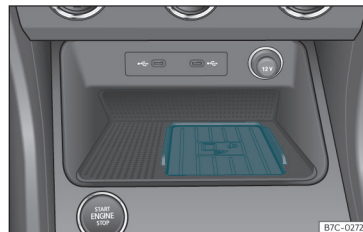
pav. 136 Vidurinėje konsolėje: mobiliojo telefono siejimo skyrius. »
