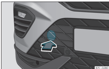
pav. 41 Dešinėje priekinio bamperio pusėje: dangtelio nuėmimas.
