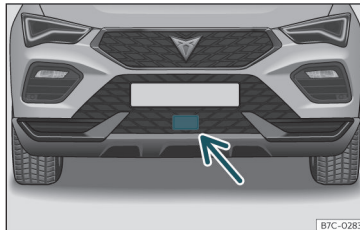
pav. 148 Priekiniame bamperyje: radaro sensorius.
