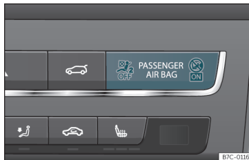
pav. 16 Prietaisų panelis: priekinio keleivio oro pagalvės išjungimo kontrolinė lemputė.
